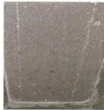
2. 11. ábra: Műanyag száladagolással készült lemez felülete 2 órás tűzteher után
