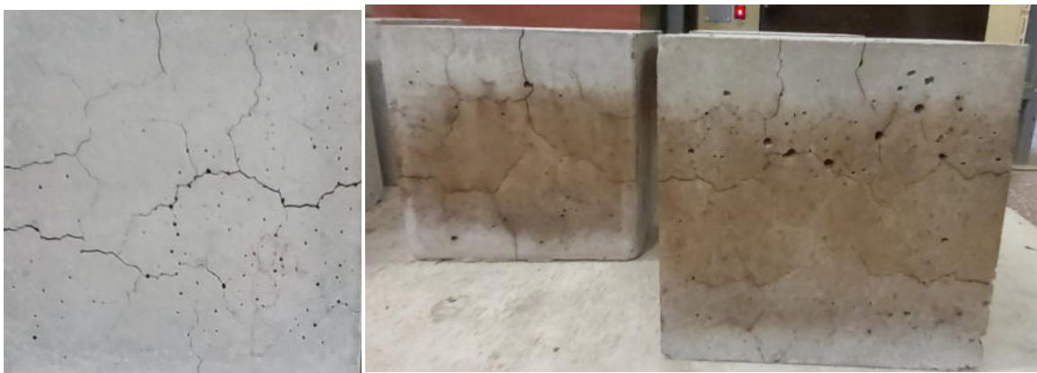
4.1 ábra: A próbatestek a 800 °C-os hőterhelést követően
