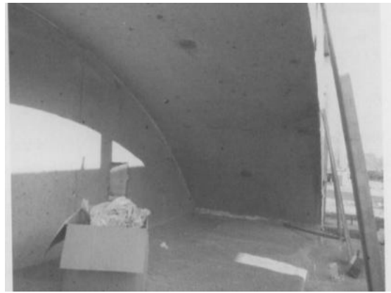
2.9. ábra: 2 kg/m 3 polipropilén száladagolással készült alagútelem 1200°C-os hőterhelés után
